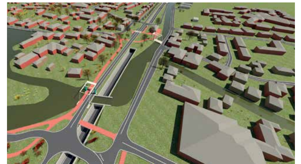
Figuur 1: kruising, aquaduct, verdiepte N247 en Dorpsplein, vanuit zuidelijke richting
